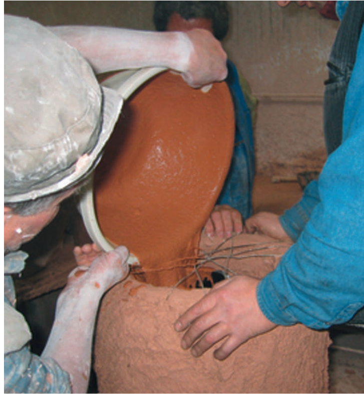
Innen mit flüssigem Schamott ausgießen
